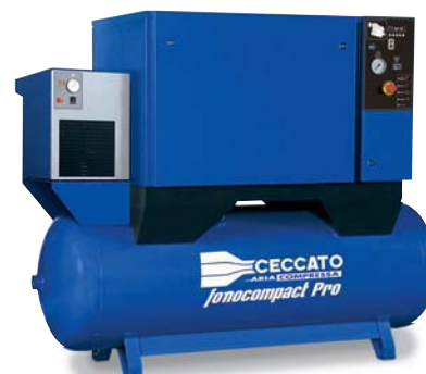
Compressore Silenzioso su Serbatoio con Essiccatore
