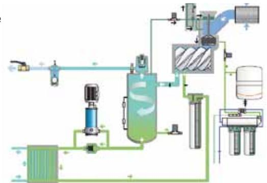
Il WIS® 40-75 con raffreddamento ad acqua condivide le stesse dimensioni e tecnologia del WIS raffreddato ad aria ad esclusione del sistema di raffreddamento. Il generoso dimensionamento del sistema di raffreddamento acqua-acqua consente basse temperature dell'aria compressa anche in condizioni di alta temperatura dell'ambiente circostante, senza l'utilizzo di alcun sistema aggiuntivo di raffreddamento acqua-aria. La caduta di pressione è minima e ciò garantisce una maggiore efficienza.
