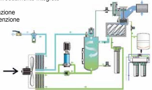
Da 40 a 75 Hp, i compressori WIS® a trazione diretta raffreddati ad aria, sono equipaggiati con un motore elettrico ad alta efficienza IP55 ed includono una turbina e un sistema di raffreddamento in acciaio inossidabile aria/aria ed aria/acqua per assicurare una bassa temperatura dell'aria in uscita. Il compressore è montato su cuscinetti idrodinamici senza nessun tipo di richiesta di ingrassaggio dei componenti.
